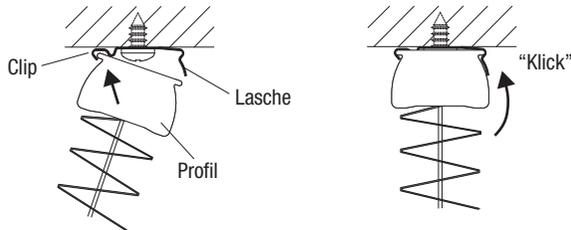
Zur **Demontage** drücken Sie die Lasche des Clips hoch, um das Profil aus dem Clip entnehmen zu können.
