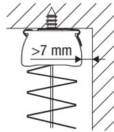
**Montage:** Die Kante des Profils schräg in den Clip (gegenüber der Lasche) einsetzen und dann in den Clip hinein schwenken bis es einrastet.
