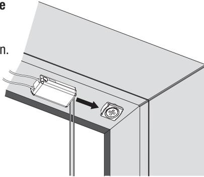
Die **unteren Spannschuhe** aus der Schiene nehmen und auf die unten montierten Befestigungsplättchen schieben, bis sie einrasten.
