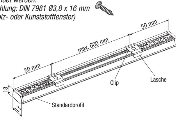
**Hinweis:** Der Clip wird vorzugsweise mit der Lasche nach vorn (Sichtseite) montiert. Der Clip kann mit der Lasche zum Fenster bzw. zur Scheibe **nur** montiert werden, wenn der Abstand zur Schiene **min. 7 mm** beträgt.
