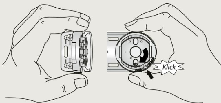
Legen Sie den Leveller in die Halterung. Stellen Sie sicher, dass die Öffnung für den Inbusschlüssel nach unten zeigt. Drehen Sie den Leveller bis er einrastet.
